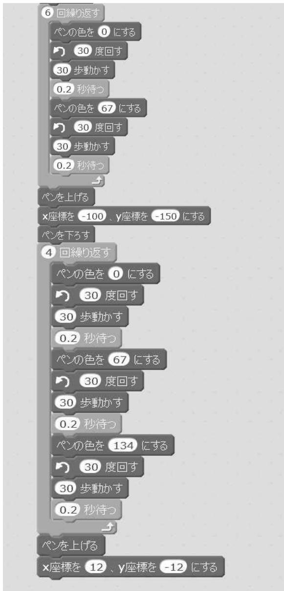
2) 同様にコマによる減算混合 (C Y M) を実験するための教材をScratchでプログラミングする。混合する色を輪にして描く。
