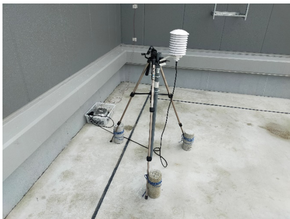
外気温計（屋上）
